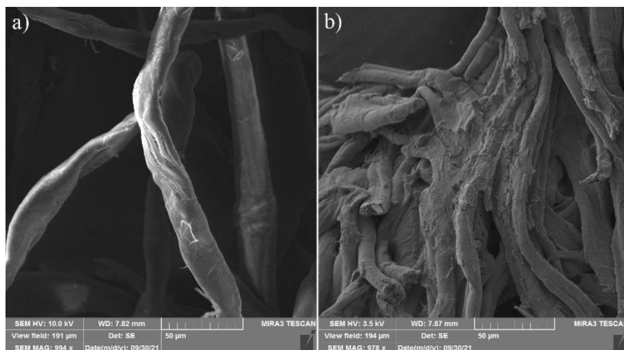
Slika 1. SEM mikrografije a) nemodifikovanog i b) modifikovanog pamučnog vlakna (TOCoL B) Izvor: Izvorno autorsko
