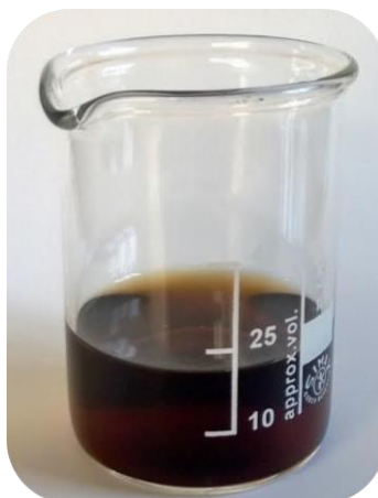
Slika 9. Procesna voda nakon razdvajanja od hidročađi
