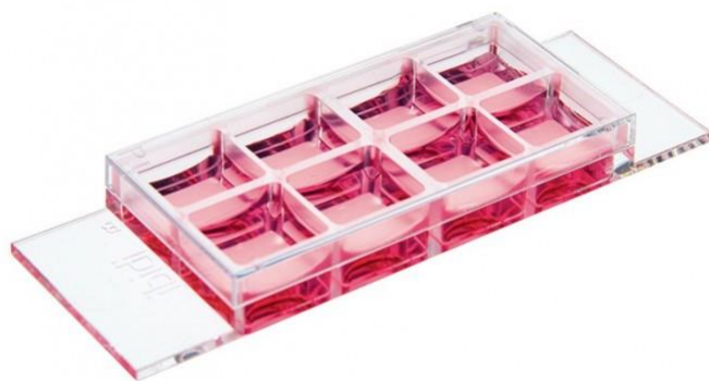
Slika 3.7.1. Pločica sa \mu -slajdovima (Ibidi GmbH) za pripremu ćelija za biosnimanja na luminescentnom konfokalnom i mikroskopu širokog polja [96].
