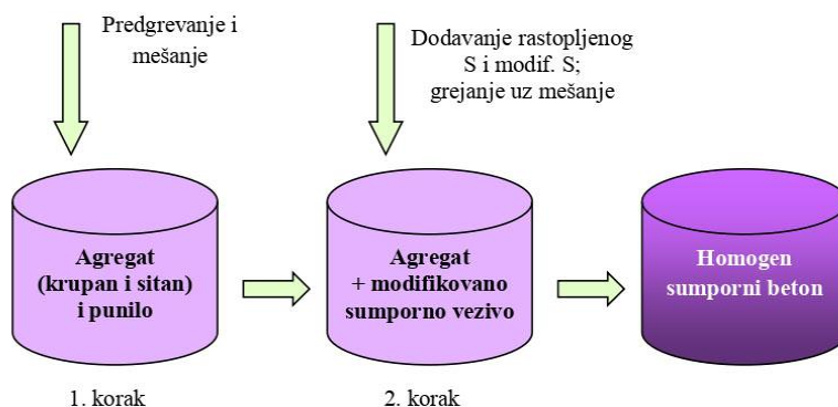
Figure 2. Slika 4. Šema pripreme sumpornog betona.
