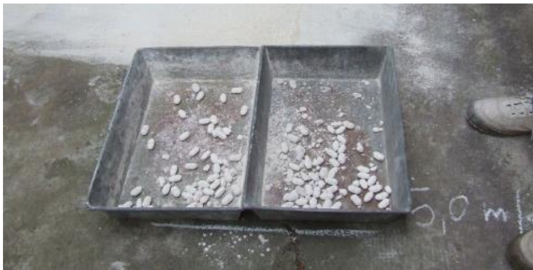
Slika 5.58. Uzorak briketa krečnjaka nakon opita pri brzini vetra od 5 m/s
