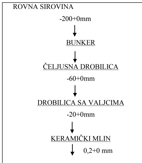
Slika 4 - Šema dobijanja mikroniziranog krečnjaka na bazi uzorka iz ležišta „Dobrilovići“
