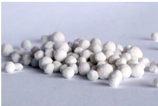
Slika 4. Kalijum sulfat obrađen vlažnom granulacijom/peletizacijom, kombinacijom pin miksera i diska za peletizaciju
