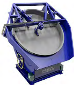
Slika 3. 3D Model disk peletizatora
