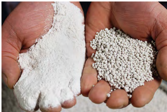
Slika 1. Kalijumov sitnozrni materijal pre i posle aglomeracije na disk peletizatoru
