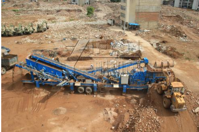
Slika 5. Mobilna drobilica za beton [13]
